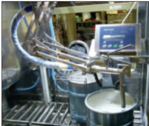
Isolatore con dispositivo di pesata e carico sostanze liquide in fusti
