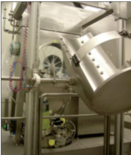
Isolatore con dispositivo di carico/scarico materia prima a "liner continuo"
