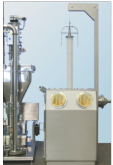
Stazione per lo svuotamento fusti mediante sonda di aspirazione
