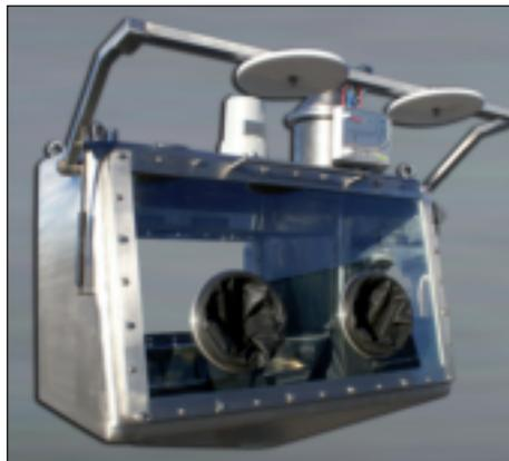
Isolatore statico per lo scarico da filtro essiccatore
