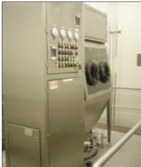
Isolatore con riciclo di gas inerte ad alto contenimento
